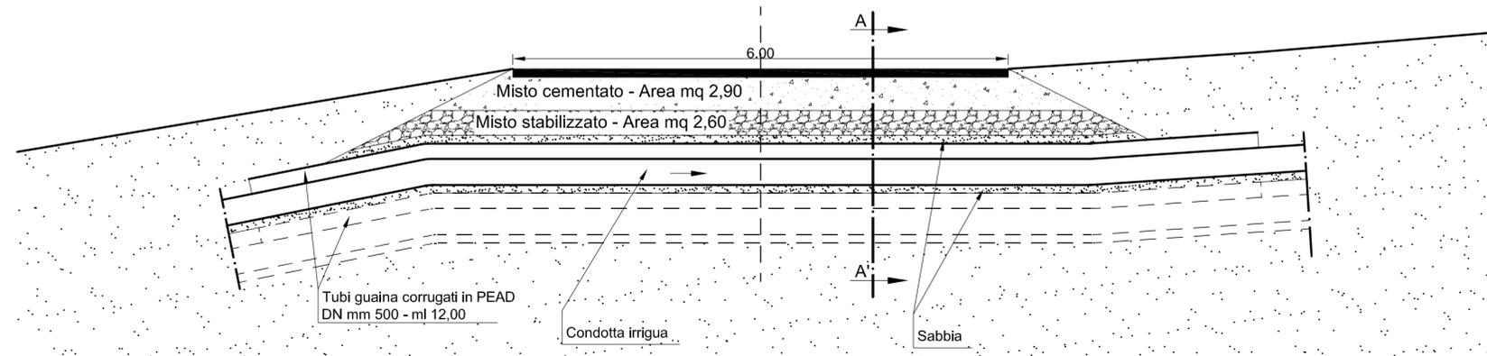
Sezione A-A' dell'attraversamento idrico
